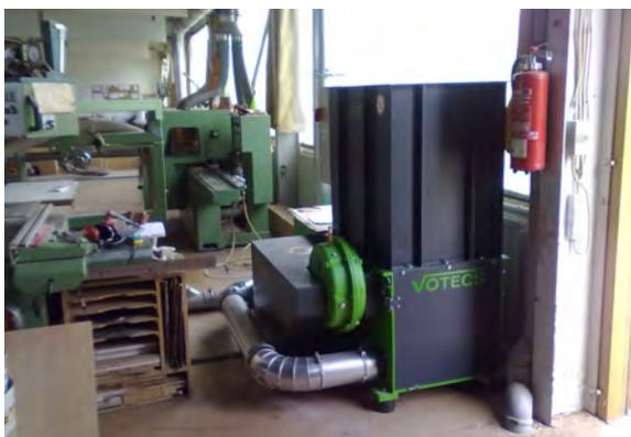
Модель EZ 6/1 рядом с панелью для измельчения остатков древесно-стружечных плит (ДСП) и панелей древесно-полимерных композитов
