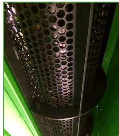
Размер щепы определяется отверстиями калиброванной сетки. При выборе размера отверстий учитывается дальнейшее использование отходов.
