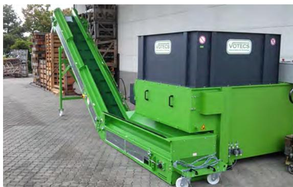
Модель EZ 13/2 с дополнительным наклонным конвейером
