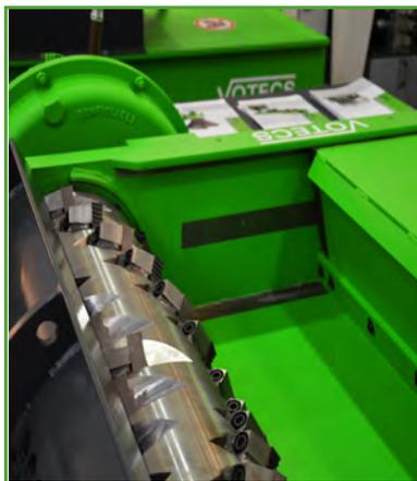
При помощи стандартного установленного толкателя материал прижимается к валу ротора. Кольцо-скат предотвращает застревание тонких материалов между толкателем и столом станка.
