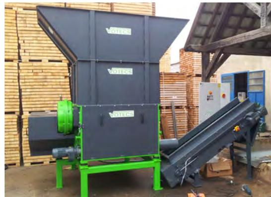
Модель EZ 10/2 с 37 кВт, заполненная отходами древесины на ленте конвейера, выгрузка материала со сбросом на ленту напольного конвейера
