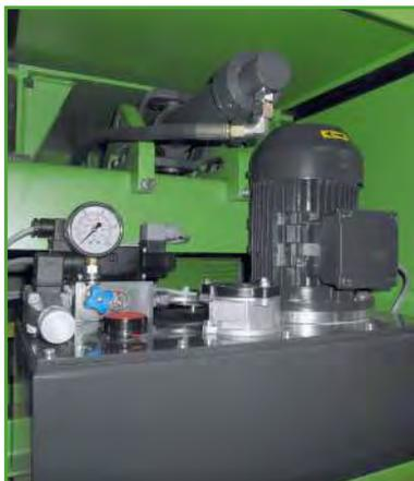
Гидравлический агрегат полностью интегрирован в корпус машины. Гидравлический цилиндр установлен на карданном подвесе, что обеспечивает длительный срок службы.
