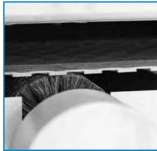
Очистка конвейера щеткой
