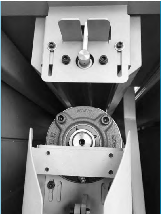
Очистка абразивных лент осциллирующими обдувками
