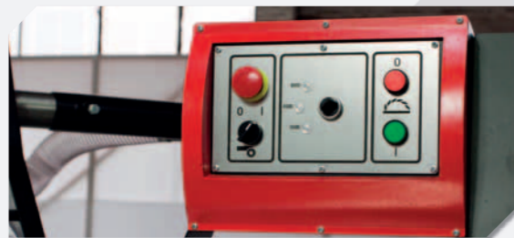
Скорость вращения главного шпинделя регулируется с выносного пульта управления
